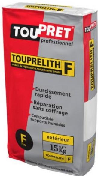
Idéal pour reboucher trous et fissures de toutes tailles sur supports bruts secs ou humides en extérieur et réparer des angles éclatés sans coffrage. Bonne résistance aux eaux de ruissellement. Bonne protection des fers contre la rouille (pH alcalin). Même coefficient de dilatation que le béton. Durcissement rapide. Adhérence exceptionnelle. Résistant aux chocs.
