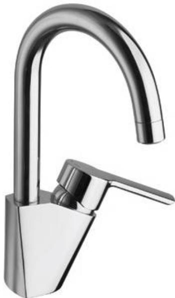
Mitigeur cartouche céramique Ø 35 mm Life Time Cristina. Axe métal, poignée métal. Flexibles de raccordement inox lavabobidet 35cm tournants anti-torsion. Aérateur anticalcaire.
