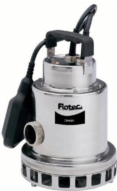
Pompe de relevage pour eaux usées tout inox avec turbine type Vortex acier inox. Passage impuretés maxi 20mm de diamètre. Automatique avec flotteur. Pression 0,7 bar.
