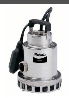
Pompe de relevage pour eaux usées tout inox avec turbine type Vortex acier inox. Passage impuretés maxi 20mm de diamètre. Automatique avec flotteur. Pression 0,7 bar.
