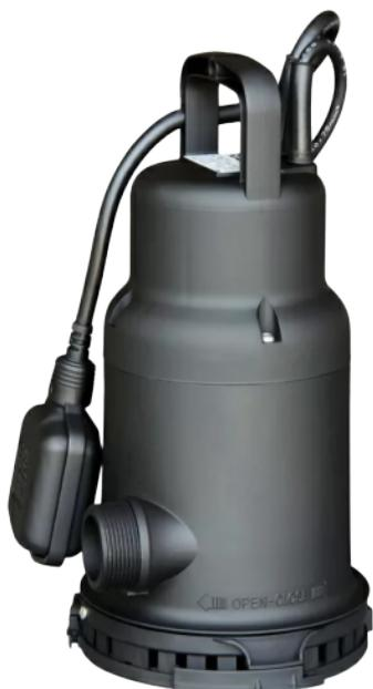
Moteur asynchrone 230 volts. Automatique avec flotteur. Pour eaux claires, passage impuretés maxi 6mm de diamètre. Niveau minimum d'assèchement 20mm. Câble d'alimentation 10m H07 RN8-F avec fiche normalisée. Pression 0,6 bar. Pour vidage de locaux inondés, vidage citerne, bassins...
