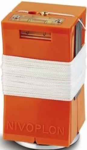
Boîtier matière synthétique avec fiole de niveau antichoc pour contrôler la verticalité. Le plomb en métal injecté et acier chromé vient se loger dans le boîtier. Le cordeau en nylon tressé de 1mm est enroulé sur l'extérieur. Le boîtier peut être accroché avec une pointe ou aimanté sur n'importe quel support métallique.
