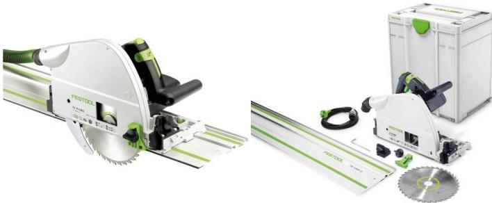
Système FastFix pour un changement simple et rapide de lame. Couteau diviseur à ressort. Emplacement butée anti-retour. Dispositif pare-éclat pour une coupe propre des 2 côtés. Réglage des joues de guidage sans outil. Ajustement de la profondeur avec précision à 1mm. Freinage de sécurité rapide SSB avec système électronique pour un travail en toute sécurité.
