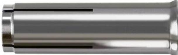
Cheville à frappe avec taraudage interne pour installation en attente. L'enfoncement du cône lors de la frappe avec l'outil de pose expande la cheville et se bloque contre la paroi.
