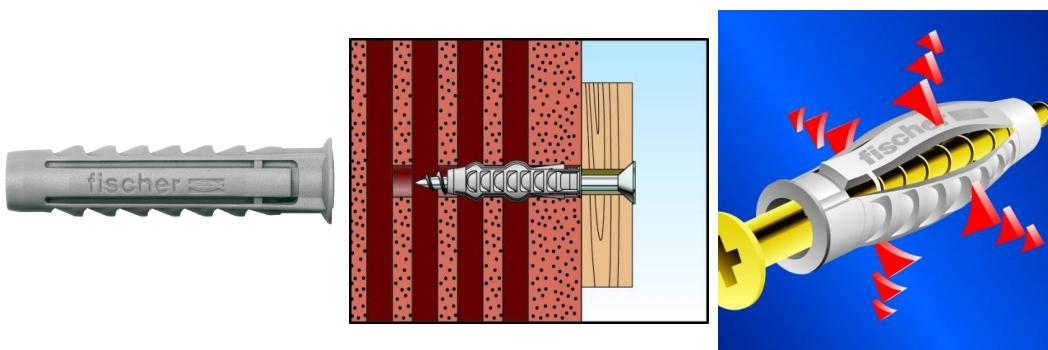
Cheville en nylon à expansion. Peut être utilisée avec des vis à bois, des vis pour panneau d'aggloméré, des vis auto-perceuse et des vis de montage à distance.
