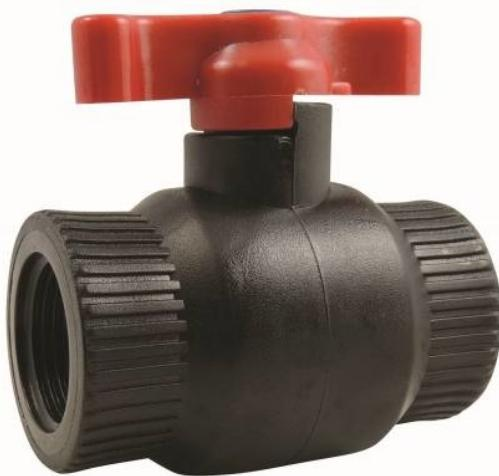
Vanne à boisseau sphérique 1/4 de tour. Corps en polypropylène avec poignée papillon, sphère en laiton chromé, axe en laiton, joints toriques en EPDM, sièges en PTFE. Résiste à une température de -15°C/+80°C. Pression nominale 16 bars.
