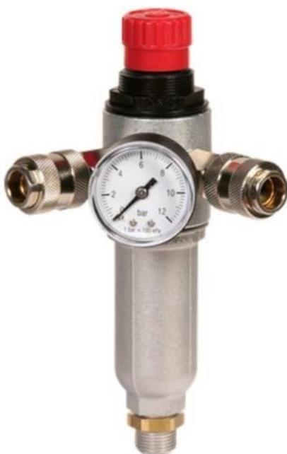
Entrée d'air 3/8" mâle. Pression d'utilisation de 0 à 12 bar. Filtre et robinet de purge. Manomètre 40mm.
