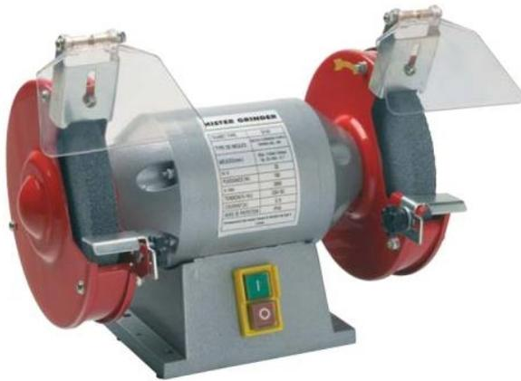
Montage sur roulements à billes. Interrupteur marche / arrêt équipé d'une bobine à manque de tension. Sécurité et conformité : pare-étincelles et porte outils réglables à 2 mm de la meule. Carters en tôle d'acier équipés d'une grille d'évacuation des poussières.
