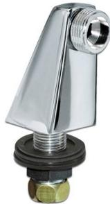
Cette colonnette de luxe permet d'adapter aisément les robinetteries murales ou sur gorge. Corps en laiton avec traitement nickel-chrome. Hauteur 70mm, raccords mâle 1/2", mâle 3/4".
