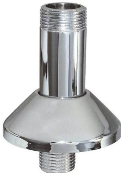
Ce raccord mâle/mâle décalé permet d'ajuster l'entraxe de l'installation par rapport à la robinetterie à installer. Corps et rosace en laiton avec traitement nickel-chrome.
