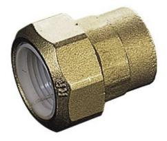
Ce manchon de réparation simple pour tube acier permet de réparer des tubes acier d'alimentation en eau ou vapeur(températuremaxi : 120°C en continu) en garantissant serrage et étanchéité. Idéal dans les endroits difficiles d'accès, sans soudure, il garantit une réparation rapide et étanche. Manchon en laiton, joint EPDM, bague inox 304 L.
