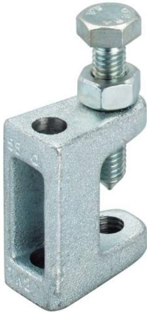
Les pinces à poutrelles offrent la possibilité de montage facile de colliers sur poutres métalliques. Haute résistance. Facilité et rapidité de réglage en hauteur. Réglage en hauteur ultérieur possible. Agréments VdS et FM. Montage sur poutres métalliques sans perçage ni soudure. Pas de glissement possible de la pince sur la poutre métallique. Pour la fixation de tuyauteries, gaines de ventilation et tuyauteries sprinkler sur poutres acier.
