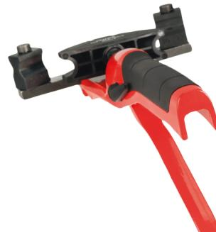
Formes de cintrage en alliage léger. Raccordement rapide. Rayon de cintrage : de 3 à 4 D. Angle de cintrage : jusqu'à 90°. Livré en coffret.
