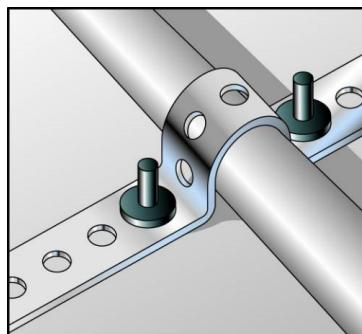
Bandé acier perforé pour montage facile et peu onéreux. Possibilité de fixation universelle. Pour la fixation de tuyauterie au sol ou au plafond.
