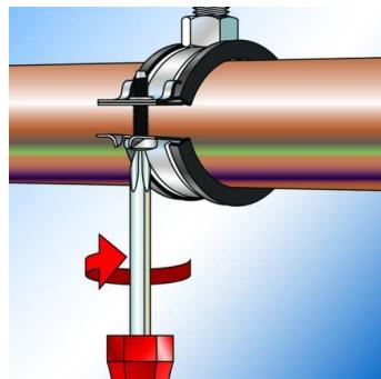
Colliers isophoniques 2 vis. Isolation acoustique pour DIN 4109. Double taraudage M8/M10 (pour la version FRS M8/M10). Large ouverture facilitant la mise en place des tuyaux. Vis imperdable à tête large et empreinte combi. Rainurage du collier assurant un maintien parfait de l'isolant. Large bande isolante pour un meilleur appui. 2 vis de serrage pour un meilleur ajustement du collier au diamètre du tube.
