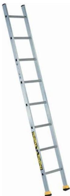
Echelle d'appui pour accéder à un point fixe. Montants et échelons en aluminium. Assemblage montants / barreaux : 3 sertissages & tulipage. Barreaux de forme rectangulaire striés et antidérapants. Angles arrondis. Patins surdimensionnés et souples pour une adhérence maximale.
