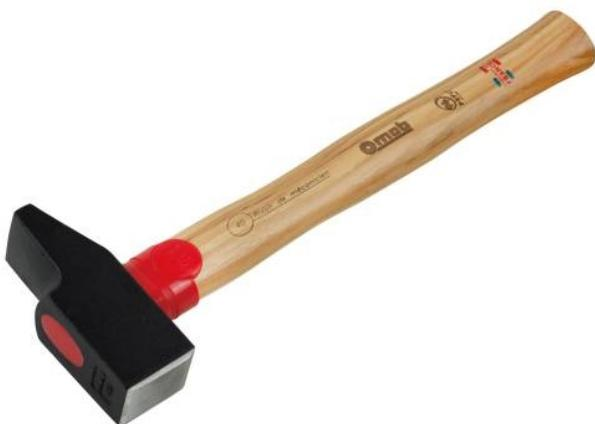
Utilisé au départ par les mécaniciens, qui recherchent à la fois de la puissance et de la précision. Tête en acier à forte teneur en carbone C45E. Tête forgée, avec traitement thermique par induction des surfaces travaillantes (54 HRC). Chanfrein de 1/20e de la tête à 45°. Manche frêne : souplesse élevée, contribuant notamment au fouet et à l'absorption des vibrations. Label PEFC (issu de forêts gérées durablement).
