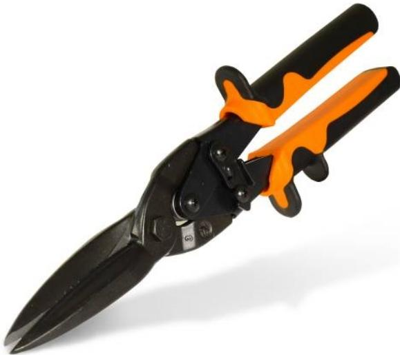
Cisaille à tôle type "Aviation" longues lames. Cisaille spéciale Zinc. Mâchoire traitée au chrome molybdène, lames longues 75mm. Ressort de rappel très puissant et résistant. Double garde protégeant le doigt de l'utilisateur. Cliquet d'ouverture automatique.
