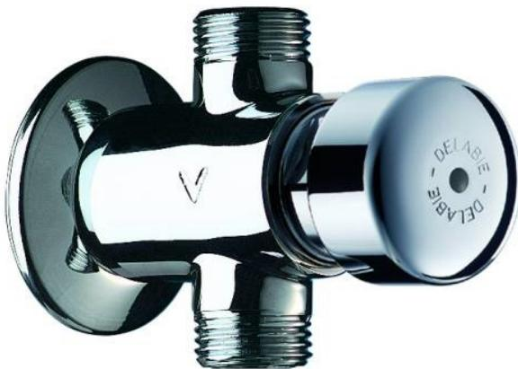
Robinet temporisé 7 sec. à poser en applique, avec raccordement en ligne mâle 1/2", pour urinoir ordinaire ou stalle. Corps et rosace en laiton massif chromé et débit 0,15 L/sec. réglable par l'extérieur sans couper l'eau ni démonter la cartouche.
