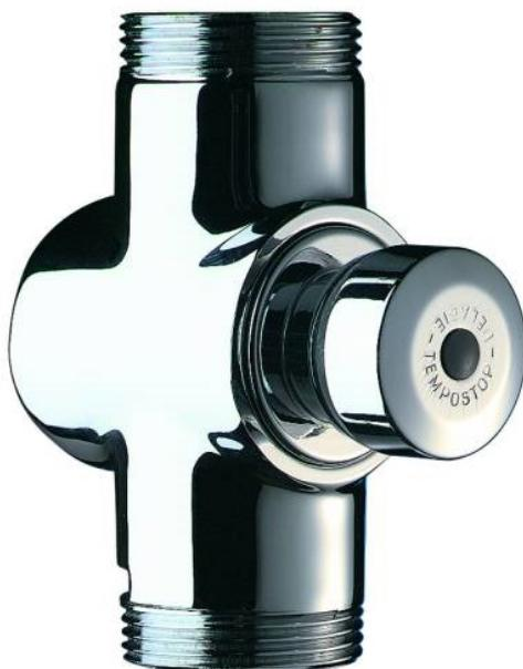
Robinet temporisé 7 secondes à bouton poussoir, apparent à poser en applique, pour chasse directe de cuvette WC traditionnelle ou siège à la turque, comprenant : bouton-poussoir et corps en laiton massif avec protection anti-siphonique, pour raccordement en ligne mâle 1"1/4. Garantie 10 ans.
