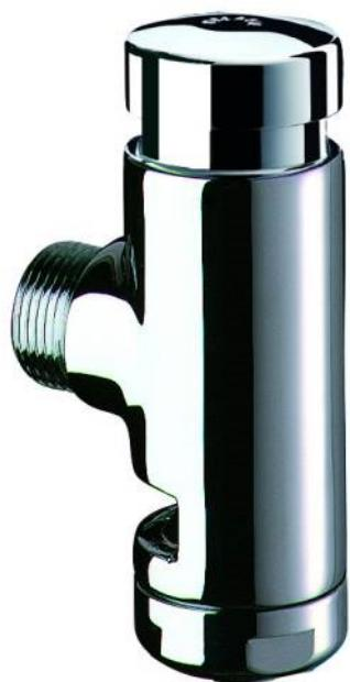
Robinet temporisé 7 secondes, apparent à poser en applique, pour chasse directe de cuvette WC traditionnelle ou enfantine, comprenant : poussoir et corps en laiton massif avec protection anti-siphonique, pour raccordement équerre mâle 3/4" avec écrou de sortie 28mm, sans tube. Garantie 10 ans.
