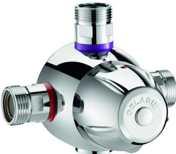
Mitigeur thermostatique centralisé pour alimentation en eau mitigée à température constante et sécurité anti-brûlure, avec butée de température maximale réglable et verrouillable, et clapets anti-retour accessibles de l'extérieur sans démonter le mécanisme. Corps en laiton DZR chromé haute résistance, et cartouche interchangeable à cellule automobile. Possibilité de choc thermique sans dépose du mitigeur.
