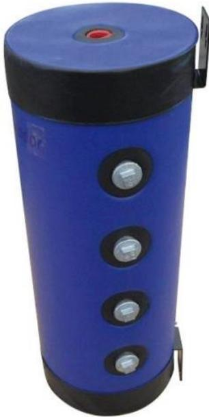
Bouteille de mélange et de décantation, pour installations de chauffage, climatisation et pompe à chaleur. Corps en acier. Réversible droite ou gauche de la chaudière. Pose murale. Modèle 50L : Raccord haut et bas de 1". Raccord coté 1"1/4x4x2. Modèle 100L et 200L : Raccord haut et bas de 1"1/4F. Un piquage face avant F 1/2" pour appoint par résistance électrique. Trois piquages face avant F 1/2" pour thermomètres ou aquastats. Pression maxi de service : 6 bar
