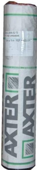
Le Paxalumin® est une chape à base de bitume oxydé, armée d'un tissu de verre, autoprotégée par une feuille d'aluminium gaufrée de 8/100ème d'épaisseur. La sous-face est recouverte d'un film plastique thermofusible. Aluminium gaufré thermo compensé insensible à la dilatation, soudable au chalumeau.
