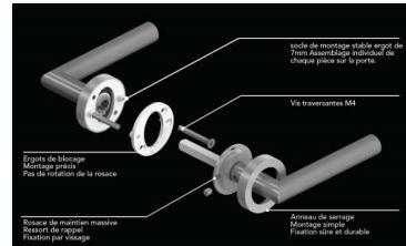
Diamètre de poignée 19 mm, rosaces 52x10mm à trois pièces avec ressort de rappel. Fixation par vis traversantes M4, avec ergots de fixation. Matériau : inox et zamac. Ensemble comprenant deux béquilles et deux rosaces.
