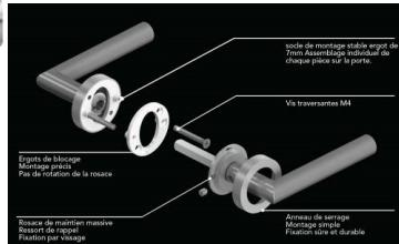
Diamètre de poignée 19 mm, rosace 52x10mm à trois pièces avec ressort de rappel. Fixation par vis traversantes M4, avec ergots de fixation. Ensemble comprenant deux béquilles et deux rosaces.
