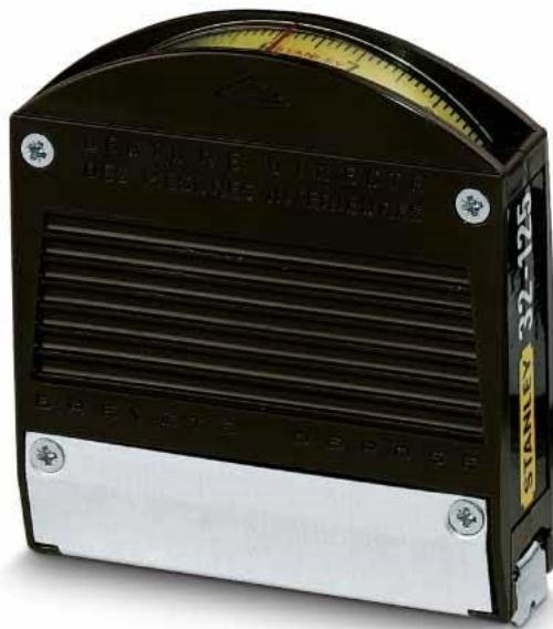
Boîtier ABS anti-choc. Lecture directe rapide et précise des mesures intérieures sous le voyant supérieur. Crochet coulissant 2 rivets pour les mesures en butée ou en accroche avec position zéro réel. Ruban en acier trempé et revêtu d'un vernis mabolon en polyamide résistant à l'abrasion et aux agressions chimiques. Retour automatique du ruban. Talon en aluminium.
