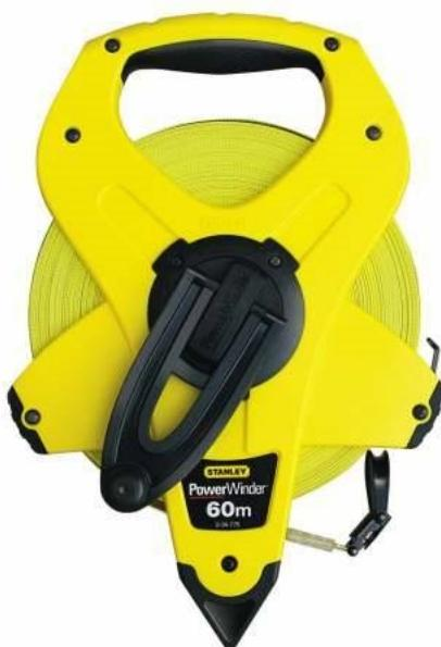
Ruban 40 fils de fibres de verre avec revêtement transparent. Rembobinage du ruban surmultiplié (1 tour de manivelle = 3 tours de bobine). Lecture facile. Palette rabattable : positionnée sur l'anneau et s'ouvrant à 90°, elle permet l'accrochage sur une arête, le piquage en terre ou dans le bois. Boîtier ABS antichoc. Patte d'accrochage permettant l'accrochage du ruban lors du transport. Grande résistance à l'abrasion. Poignée bimatière ergonomique.
