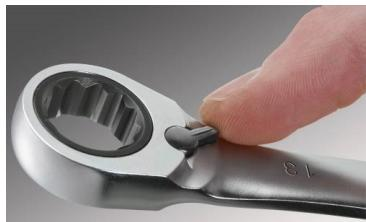
Clés à cliquet Ultra-Grip : jonc de retenu sur l'oeil + encoche anti-ripage sur la fourche. Ne glisse pas sur les écrous, sécurité optimale. Mécanisme à cliquet compact, réversible par levier. Meilleure accessibilité. Angle de reprise à 5°. Oeil et fourche inclinés à 15°. Chromée satinée.
