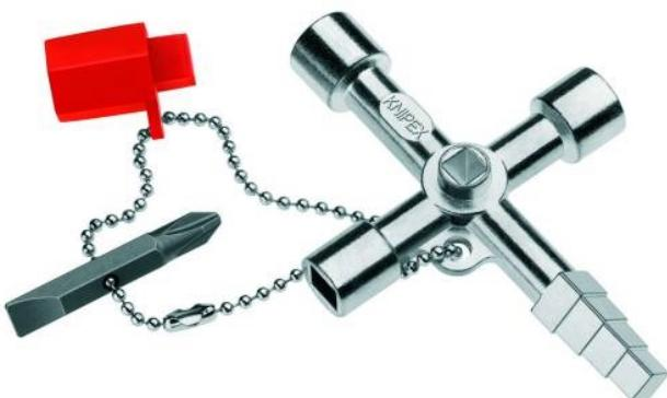
Pour les installations de chauffage, de climatisation, sanitaires et dans des bâtiments, par ex. pour les poignées de portes et de fenêtres ou pour les dispositifs d'aération de chauffage. Avec embout réversible 1x7mm plat et cruciforme PH2, adaptateur pour embouts de 1/4" et chaîne de fixation. Logement d'embout additionnel pour embouts de 1/4" dans une branche. En zinc moulé.
