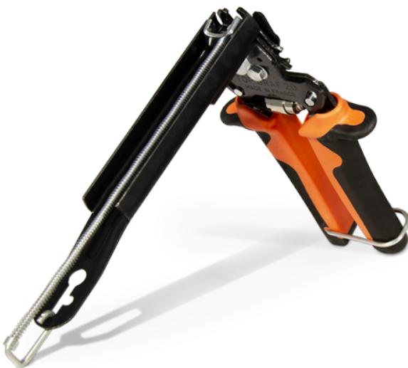
Agrafeuse manuelle à grillage avec chargeur. Outil léger et maniable. 2 coupe-fils intégrés jusqu'à 3 mm d'épaisseur. Chargeur en acier traité d'une capacité de 50 agrafes. Vis moletée pour démontage rapide (encombrement réduit). Compatible avec agrafes Delta 22 et Omega 20.
