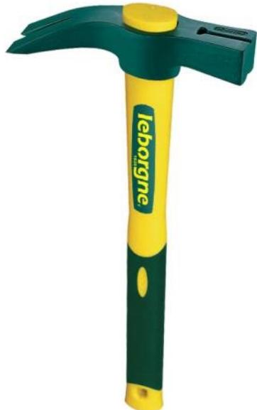
Outil forgé et trempé pour une meilleure résistance à l'usure. Surface de frappe et griffes rectifiées pour plus de sécurité. 2 empreintes porte-clou au dessus et en dessous de la tête. Manche Novagrip, noyau en fibre de verre, poignée élastomère anti-glissement. Pour tous travaux de maçonnerie, de charpente et de coffrage.
