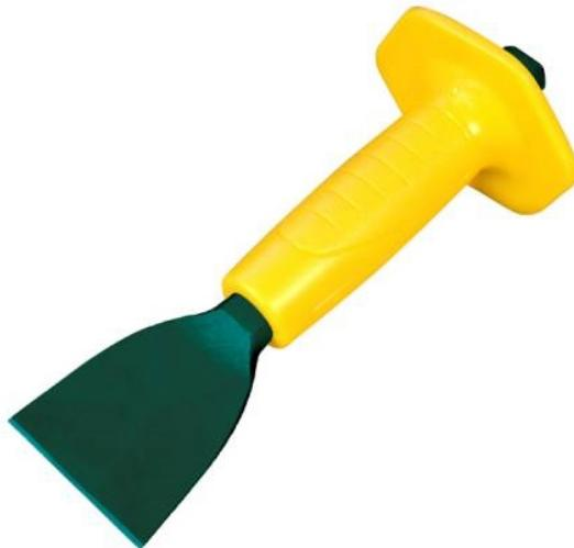
Outil large (70mm) avec un taillant fin, idéal pour couper les briques, décoller du carrelage, surfacer de la pierre ou du béton. La finesse de la lame permet au ciseau à brique de conserver son efficacité dans le temps. Acier au carbone forgé, trempé et revenu.
