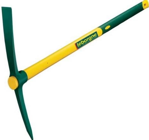
1 côté panne pour creuser, couper les racines. 1 côté pic pour dépierrer, déssoucher. Pointe diamant et panne affûtée. Acier haute résistance trempé. Manche fardelé permettant un gain de place en linéaire. Manche Novagrip en fibre de verre, poignée élastomère anti-glissement et anti-vibration. Pour le terrassement et les gros travaux du jardin.
