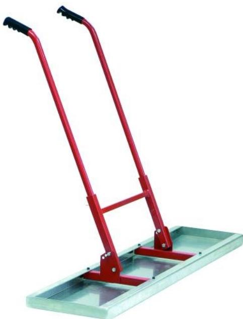
Lissarde à béton, pour répartir et lisser le béton. Structure acier finition époxy. Confort amélioré grâce d'une part au réglage de l'inclinaison des bras en 3 positions (40°, 55°, 70°) et d'autre part au réglage de leur longueur de 74 à 90cm. Plateau en aluminium pouvant être lesté. Entièrement démontable.
