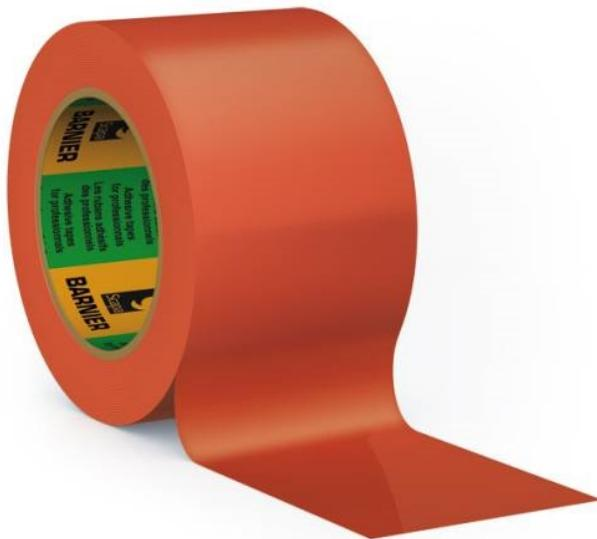
Le ruban PVC SCAPA 6095 est le ruban à tout faire du bâtiment en gros oeuvre, second oeuvre et finitions (réparation, obturation, étanchéité, masquage, protection, maintien et jointage de bâches). Adhère sur tous les supports même poussiéreux et humides. Résistant et conformable, souple même à basse température. Déroulement facile, déchirable à la main.
