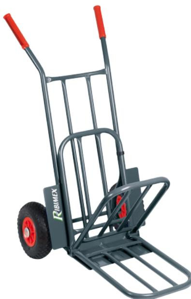
Diable en métal peint époxy. Axe de roues et bavette renforcés. Equipé de 2 poignées en plastique moulé. 2 roues increvables Ø 260 mm. Bavette rabattable 52x33cm. Hauteur 128cm, largeur 48cm, longueur 56cm.
