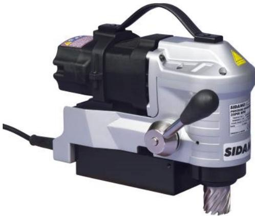
Moteur horizontal pour une hauteur de la machine de 200mm. Système de broche à emmanchement rapide. Poignée positionnable à gauche ou à droite. Perceuse magnétique très compacte et robuste. Éclairage à LED proche de l'outil pour les endroits sombres. Base à forte attraction magnétique de 15000N. Écran de protection.
