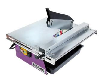
Machine portable légère pour disque diamant de 180mm. Plan inclinable permettant les coupes à angle droit et en biseau (45°). Bac à eau pour le refroidissement du disque. Protection totale du disque par carters latéraux. Couteau diviseur.
