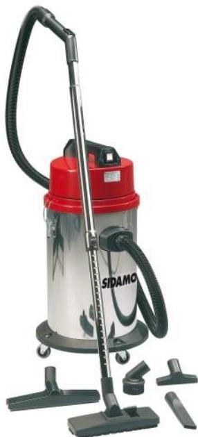
Aspirateur eau et poussières équipé d'un filtre classe L de série. Moteur conçu pour des utilisations intensives. Aspiration bi-turbine. Moteur à refroidissement de type by-pass (de l'air est aspiré par une 3ème turbine au-dessus du moteur uniquement pour le refroidissement). Socle à 4 roues pour une mobilité optimisée. Flexible armé anti-écrasement. Fabrication européenne.
