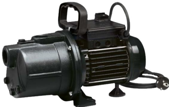
Pompe à moteur électrique asynchrone monophasé avec protection thermique incorporée et système hydraulique monoturbine type JET pour assurer une efficacité supérieure. Corps de pompe en fonte. Pour irrigation de gazons et plates-bandes, lavage de terrasses et de sols extérieurs, remplissage ou vidange de réservoirs et bassins...
