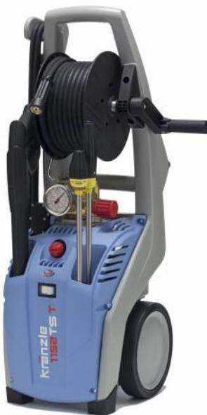
Nettoyeur haute pression eau froide avec chariot intégré. Système total-stop. Régulation progressive de la pression et du débit. Tête de pompe en laiton spécial, pistons céramique. Sécurité contre la marche à sec. Logements pour pistolet et lance. Injecteurs de produits additifs avec filtre.
