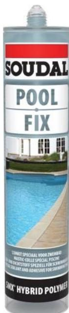
Mastic-colle à base de MS Polymères pour la réparation provisoire de liner. Idéal pour l'étanchéité des pièces de piscine (skimmer, bonde de fond). Collage de mosaïques et carrelages (hors d'eau et en eau). Réparation temporaire de petites fissures. Ne convient pas pour des réparations permanentes, des canalisations sous pression ou des réparations structurelles.
