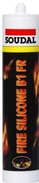
Le Fire Silicone B1 FR est un mastic monocomposant neutre et élastique à base de silicium pour tous joints devant résister au feu. Conformément au standard DIN4102B1. Résistance au feu jusqu'à 4 heures (EN 1366 Part 4-NBN712.020-BS476.20).
