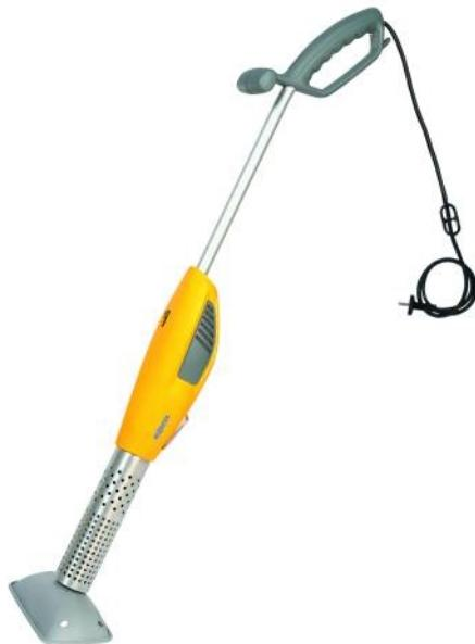
Efficace et précis, permet de détruire uniquement les mauvaises herbes sans toucher les plantes avoisinantes. Sans flamme. Léger et simple à utiliser, le désherbeur électrique crée un choc thermique (600°C) qui fait éclater les cellules végétales pour détruire les mauvaises herbes sans l'utilisation de produits chimiques. Utilisable en agriculture biologique. Véritable alternative aux désherbeurs à gaz, le désherbeur électrique permet d'entretenir vos allées, cours, massifs, potager...
