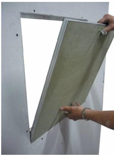
Trappe murale ou plafond pour le plaquiste. Profilé aluminium, ouvrant BA13 hydrofuge. Cadre dormant et ouvrant aluminium. Joint caoutchouc d'étanchéité fixé à l'intérieur de l'ouvrant. Ergot de centrage. Ouverture par serrure batteuse. Finitions invisibles car le cadre dormant vient à fleur du BA13. Se pose au mur ou au plafond. A peindre ou à tapisser.
