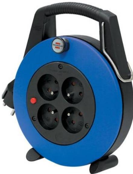
Enrouleur de câble 4 prises 2P+T 16A/230V, disjoncteur thermique. Puissance maxi câble déroulé 2300W, câble non déroulé 700W. Protection enfants.
